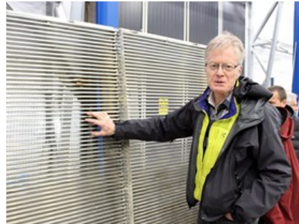
Henrik Thomke vid ett av de galler som testas för att avleda fisk till passager förbi kraftverksintag.
