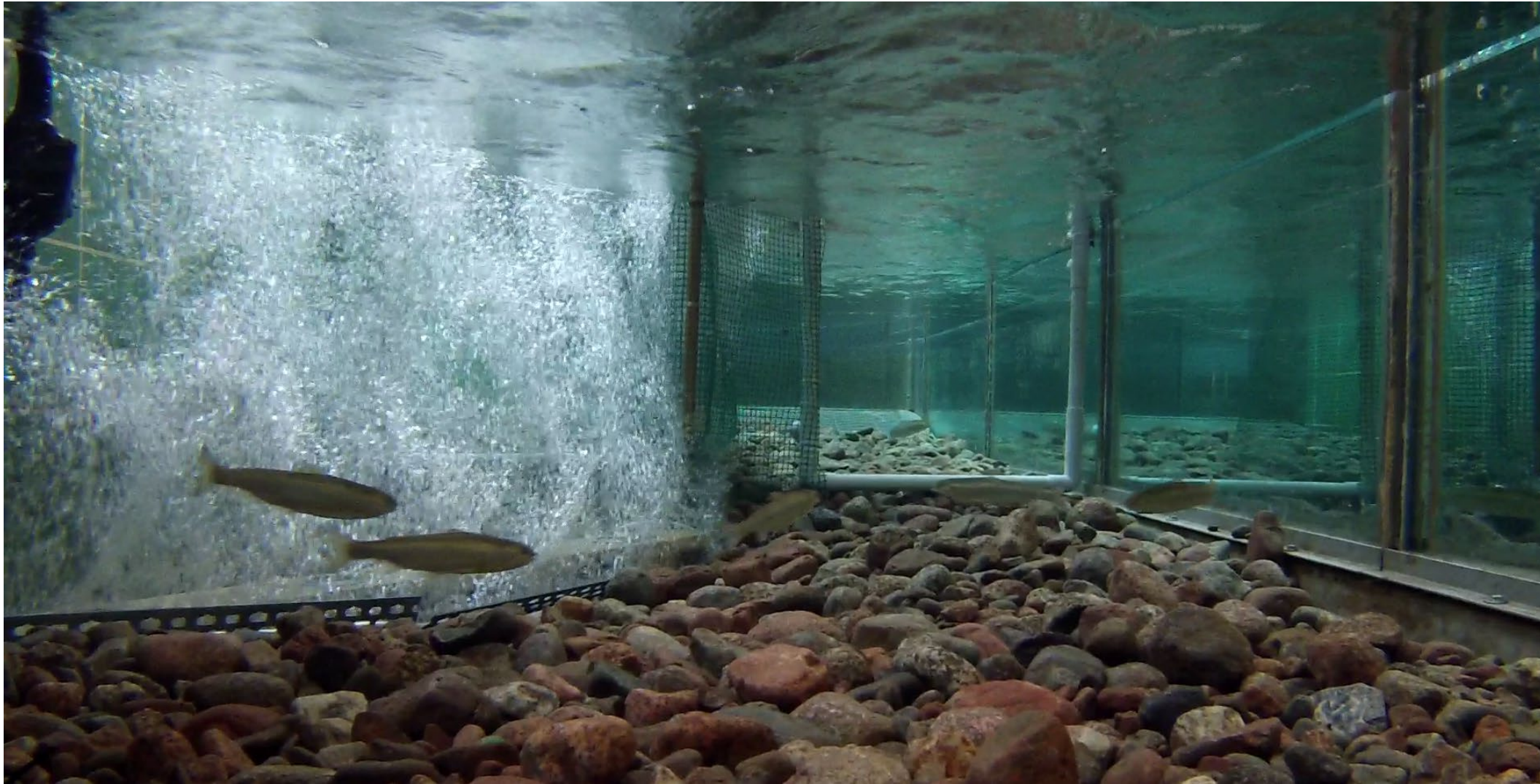
Strömakvarie, 35 000 l, kontrollerbar strömhastighet 0-1,2m/s
