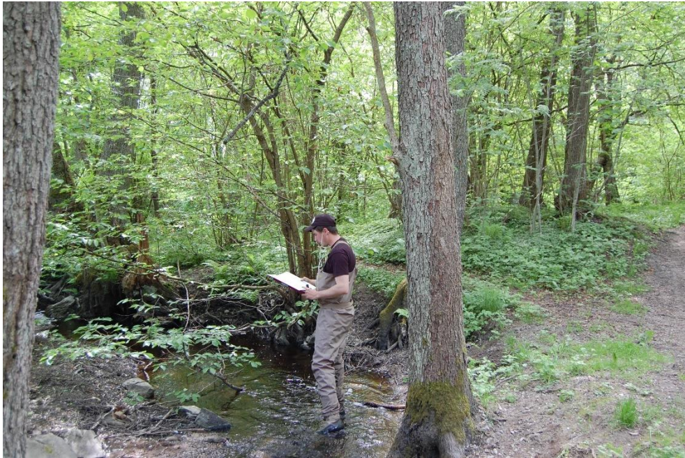
Figur 2. Bilden visar hur en mer noggrann kartering av bottenstrat görs. Samtidigt som bottenstratet känns av med foten så förs anteckningar.
